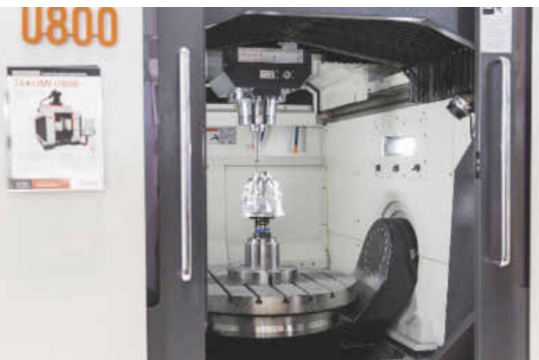
Die neuen 5-Achs-Bearbeitungszentren der U-Baureihe von Takumi ermöglichen die schnelle und präzise Bearbeitung von Werkstücken mit hoher Oberflächengüte. Bild: Hurco / Takumi
