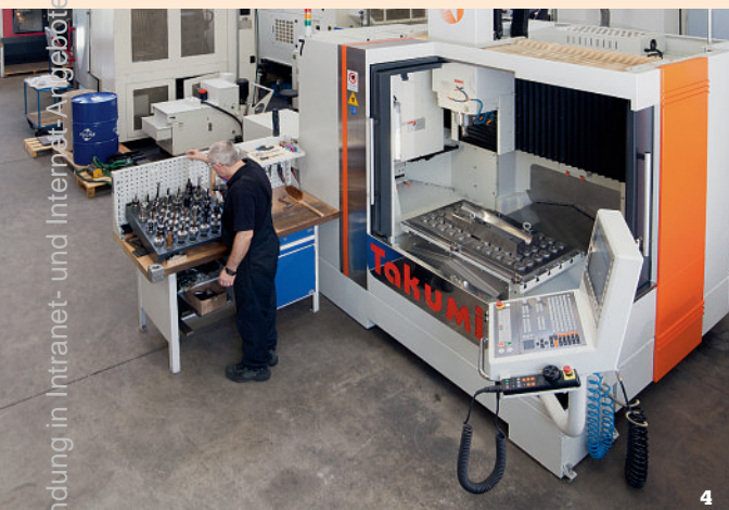
3 Bei Völcker & Wiens stehen ausschließlich CNC-Drei-Achs- und -Fünf-Achs-Maschinen mit einer Heidenhain-Steuerung 4 Takumi-Bearbeitungszentrum H10: hohe Leistung auf wenig Raum. 5 Formwerkzeug bei Völcker & Wiens: Oberflächenqualität mit Wow-Effekt.
